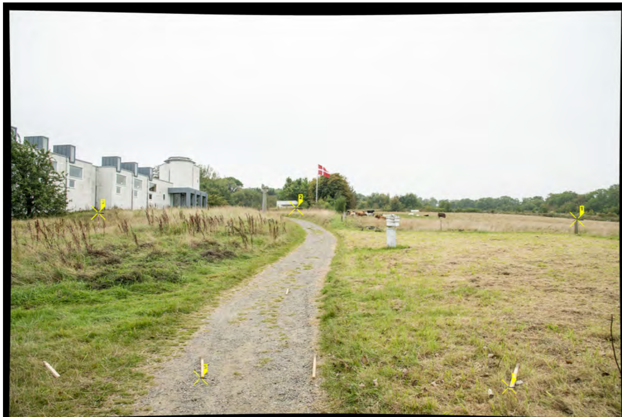
Billede eksempel på de punkter der er indmålt for et fotostandpunkt. Disse punkter bruges til placere billede og model korrekt i et 3D modeleringsprogram
